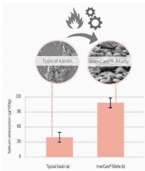
A differenza del caolino convenzionale lamellare, ImerCare® Matte subisce un processo fisico che ne modifica la morfologia permettendogli di acquisire una struttura microporosa ed una più estesa area superficiale.
